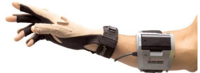
Dispozitivul haptic „CyberGlove” [VRLOGIC Inc.]
