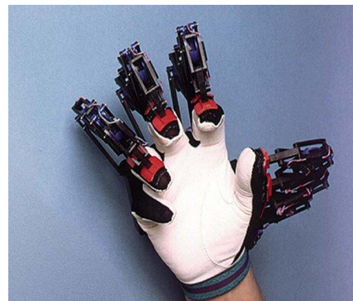
Dispozitivul haptic EXOS Dextrous Hand Master. [Exo Inc.]
