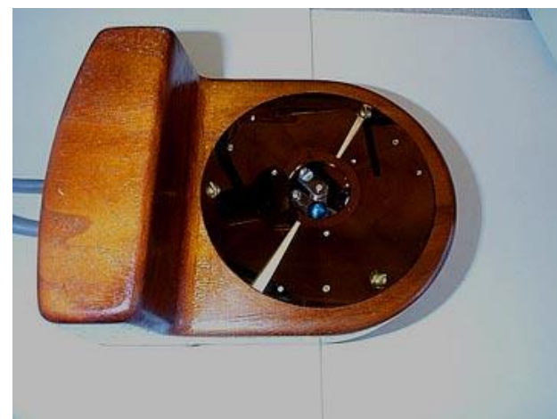
Dispozitivul haptic PBFD [Univ. of Washington]
