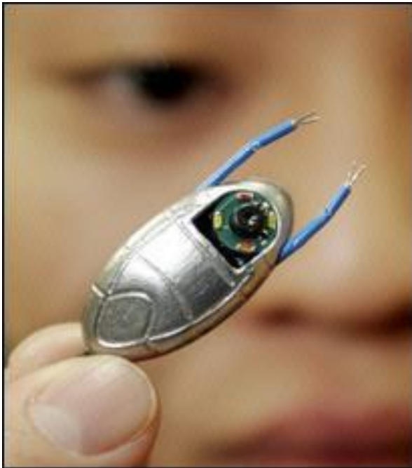
In-vivo Micro Robot, pentru monitorizare abdominala
