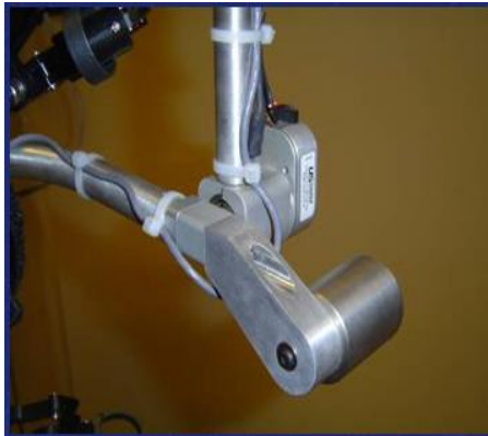
Dispozitivul haptic „CyberTrack” [VRLOGIC Inc.]
