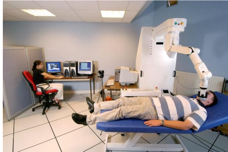
Robotul Hippocrate, brat robotic pentru radiografie
