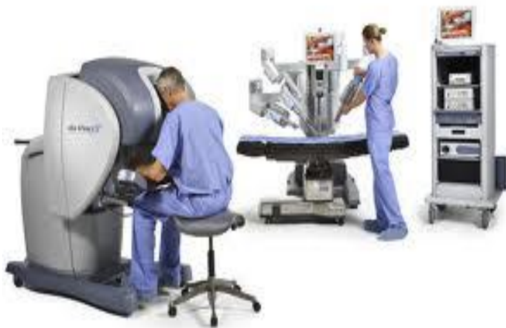
da Vinci (1998) sistem robotic complex utilizat într-o gamă largă de proceduri chirurgicale [INT12]
