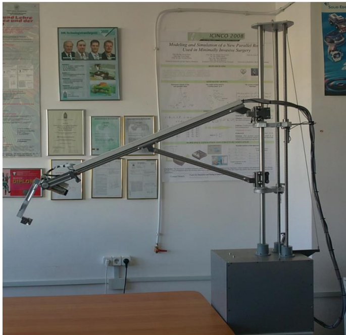
Parasurg 5M (2010) robot paralel hibrid cu 5 GDL utilizat în CMIAR [GHE11],[PIS11]
